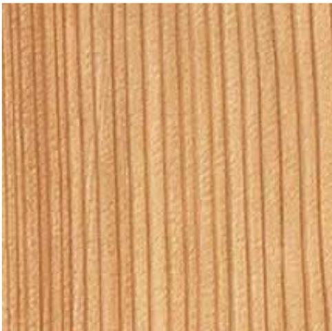
**Larice:** Buone caratteristiche meccaniche e di durezza, ampiamente utilizzato per le strutture esposte agli agenti atmosferici, aspetto particolarmente piacevole
