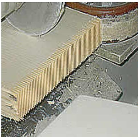
**Fig. 3** : Fresatura della testa a pettine
