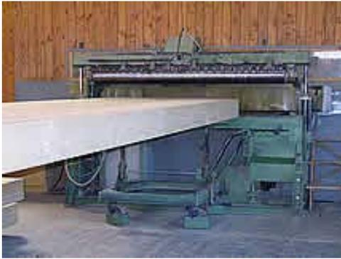
**Fig.7** : Piallature delle travi
